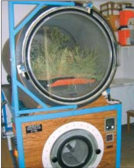
**Abb. 2: Gefriertrockenanlage des Biologiezentrums.**
