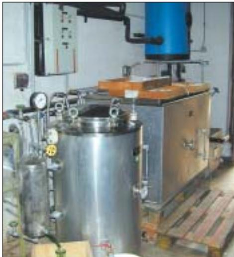
**Abb. 3: Entfettungs- und Mazerationsanlage.**
