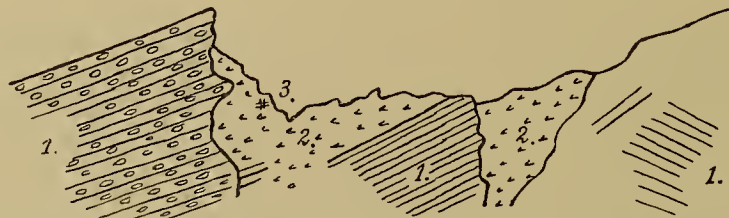
Fig. 1. Rechtes Thalgehänge W. von Balta-Liman. 1. Knollenkalk. 2. Serpentinisirtes Eruptivgestein. (3. Faseriger Serpentin.)
