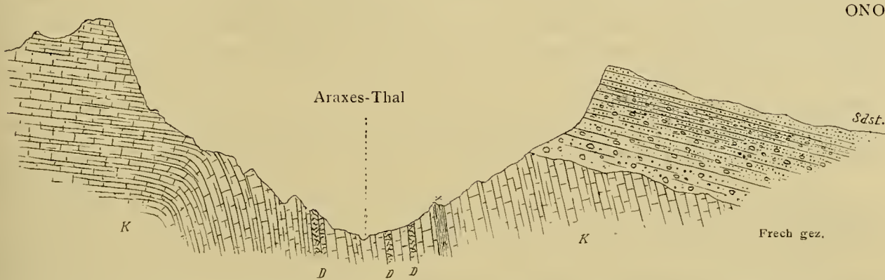
Fig. 30. Profil durch die Araxes-Enge oberhalb Alt-Djulfa. K = Mergelkalk; D = Diabaslager; X = Fundort; zwischen diesem und dem obersten Diabaslager eine Bank dolomitischen Kalkes; Sdst. = rothe Conglomerate und Sandsteine des Eocän.
