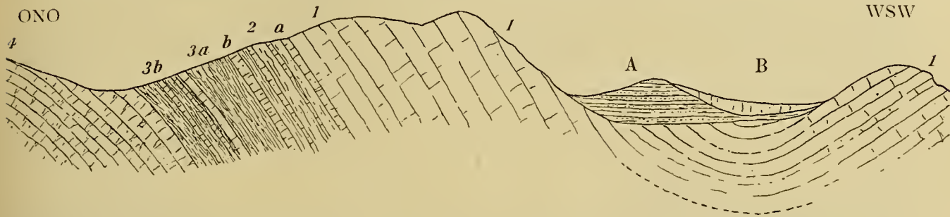
Fig. 27. Querprofil durch die Mündung des Arpatschai-Thales (Gouvernement Eriwan, Hocharmenien) (nach Lethaea, Theil I, Bd. II, pag. 295). A = Neogen; B = Löss; 1-4 gefaltete mittelpaläozoische Schichten (die Faltung ist jung- oder post-carbonisch). 1 = oberes Untercarbon, dunkle, dickbankige Kalke mit zahlreichen Korallen , Euomphalus , Productus semireticulatus . 2 = unteres Obercarbon, Mergel und schiefrige Kalke mit Spirifer tornacensis und Spirifer Verneuili , a mit b ohne Dalmanella Michelni . 3 = oberes Devon, Thonschiefer und mergelige Kalke mit Spirifer Verneuili . 4 = oberstes Devon, Kalke.
