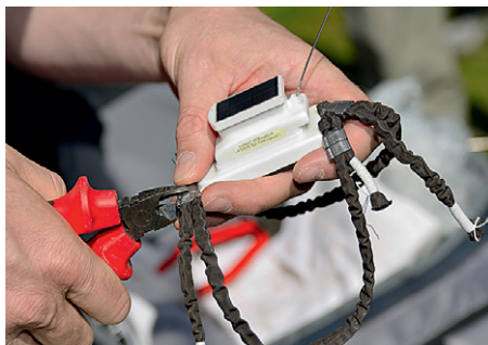
Montage des solarbetriebenen Satellitensenders; Foto: NP Hohe Tauern Salzburg
