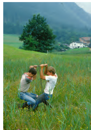
Abb. 3: Handbohrung mit der Dachnowsky-Sonde. Rechts Maurice Chédel, links Stephan Bader. August 1984.
