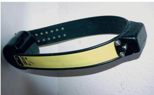
Abb. 1 Senderhalsband der Firma Vectronic-Aerospace
