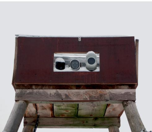
Abb. 6 Mittels Kamertechnik werden ab 2004 alle Wildpassagen über die Wildbrücke erfasst und aufgezeichnet.
