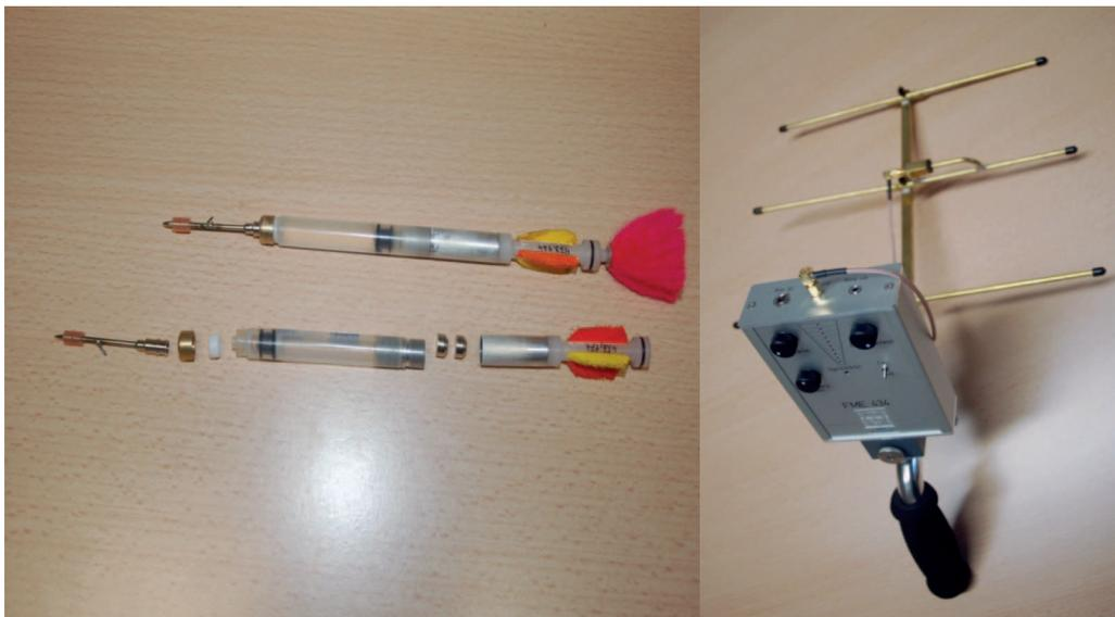
Abb. 3/1-2 Besondere Narkosepfeile der Firma AWEK mit einem für diese Pfeile entwickelten Richtfunkempfangsgerät (Fotos: E. Gleich)
