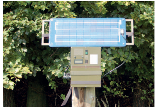
Abb. 4 Anbringung eines Batty-Gerätes mit kombinierter Blei-Akku-Gel-Solarpanel-Energieversorgung. (Foto: E. Gleich)
