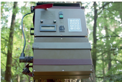
Abb. 1 Der Untersuchungsgegenstand: „Batty“ – ein Gerät zur Wildabwehr unter Einsatz von Ultraschalltönen
