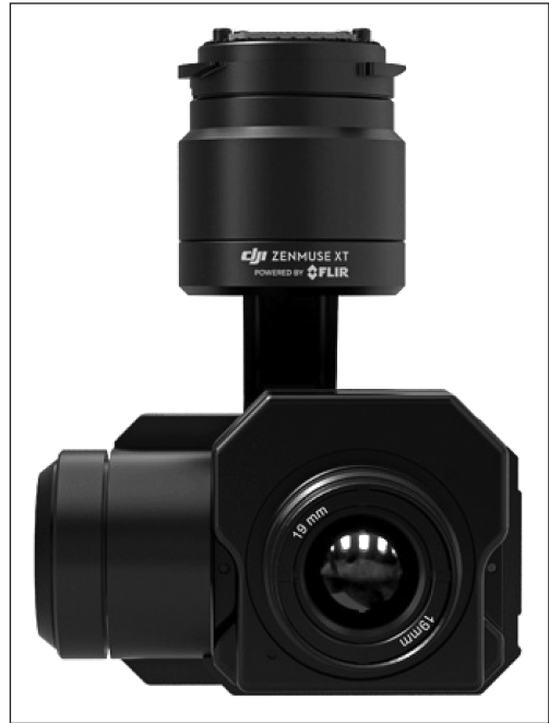
Abb. 5: Wärmebildkamera Zenmuse XT ( http://www.dji.com/inspire-1/camera#xt )
