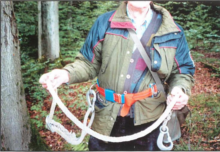
Abb. 3: Friedhelm Hochrath mit Kletterausrüstung: Beckengurt, Karabinerhaken + Halteseil, Tragetasche mit Werkzeug
