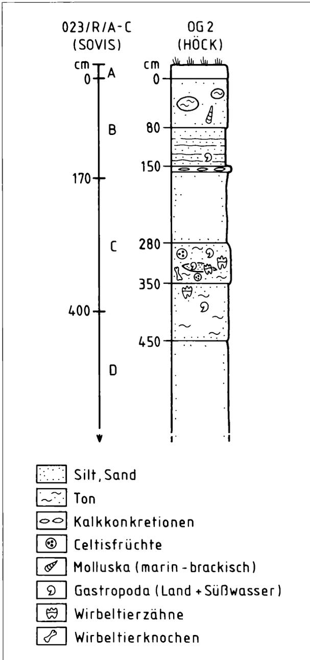
Abb. 3: Aufschlußskizze und Profil Obergänserndorf /Aufschluß OG2
