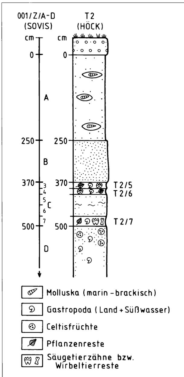
Abb. 2: Aufschlußskizze und Profil Teiritzberg /Aufschluß T2
