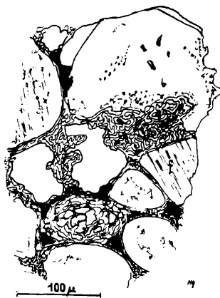
Abb. 16 Ausbildung des difformen Zements als schwammartige Masse, als Korn mit Randundulation und als glasklare, fremdgestaltige \text{SiO}_2 -Bildung (Mitte der Abb.) — f = Feldspat; Bild oben: Verwittertes klastisches Quarzkorn. Verwitterung am stärksten in der einschlußreichen Korngegend; schwarz: Brauneisen.
