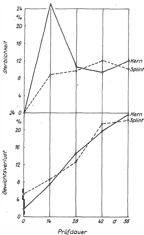
Fig. 3. Gewichtsverlust und Sterblichkeit in Abhängigkeit von der Prüfdauer bei von *Coniophora cerebella* angegriffenem Douglasienholz
