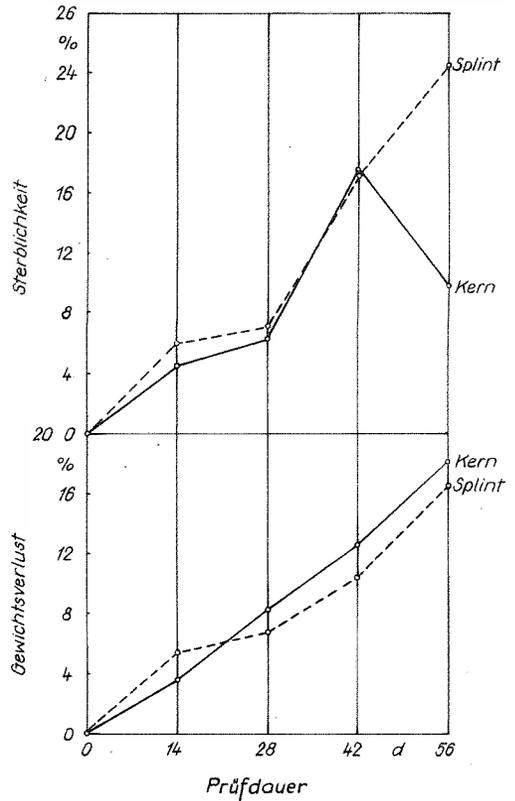
Fig. 2. Gewichtsverlust und Sterblichkeit in Abhängigkeit von der Prüfdauer bei Douglasienholz
