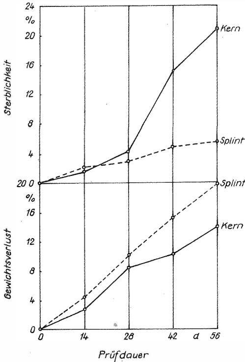
Fig. 1. Gewichtsverlust und Sterblichkeit in Abhängigkeit von der Prüfdauer bei Kiefernholz
