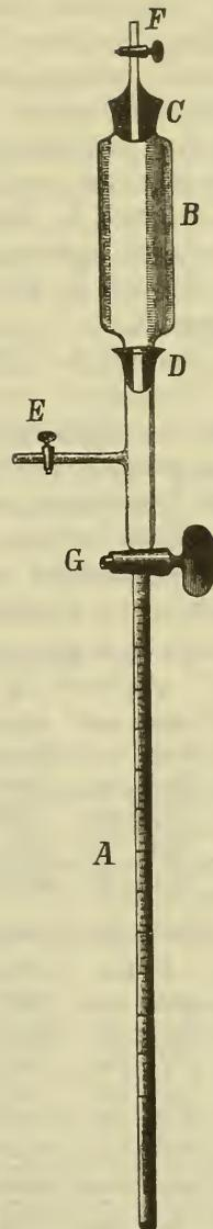
Versuch 1. In das Gefäß *B* wird ein Becherglas mit Kalilauge und befeuchtete Glaswolle eingeführt, und der Apparat mit Stickgas gefüllt. Nachdem dann der Hahn *G* geöffnet war, wurde eine Stunde gewartet, während welcher Zeit die etwa vorhandene Kohlensäure absorbiert sein musste. Alsdann wurde der Hahn *G* wieder geschlossen, das in *A* enthaltene Gas gemessen und 8,85 ccm Alkohol hinzutreten gelassen, nach zwei Stunden wieder abgelesen.
