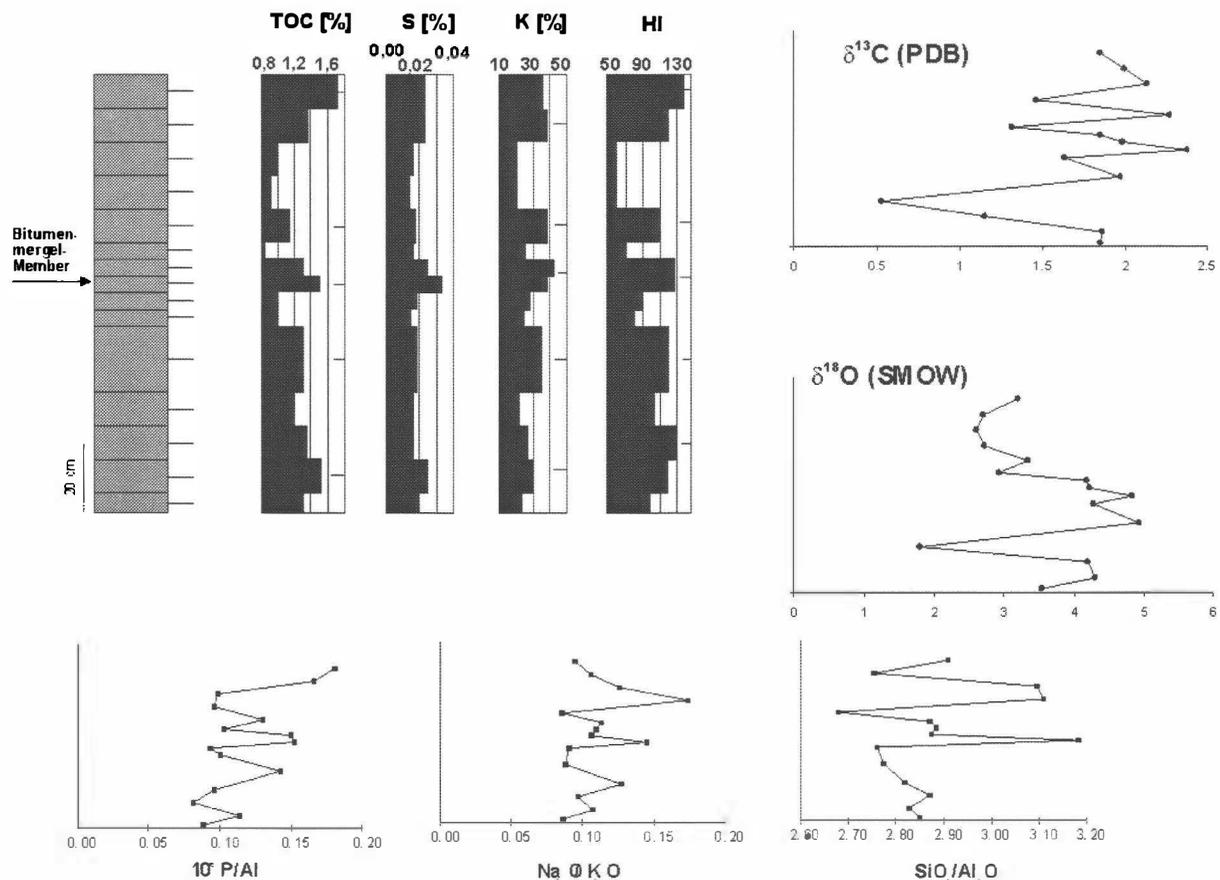
Abb. 5: Profil in der Bitumenmergel-SbFm. der St. Pankrazen-Fm. am Haltepunkt 2 mit einigen geochemischen Parametern: TOC = organisch gebundener Kohlenstoff; S = Schwefel; K = CaCO<sub>3</sub>; HI = Wasserstoff-Index. Zusätzlich sind einzelne deutliche Maxima eines (ca. 20-40cm mächtigen) Geochemie-Zyklus markiert (s. RUSSEGGER et al., 1998).
