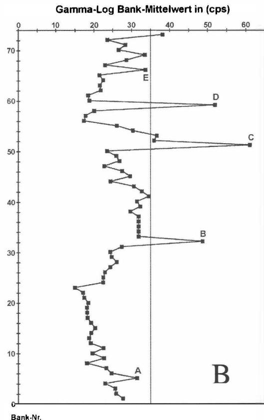
Abb. 3: A: „Kontinuierliches“ Gammalog. Natürliche Gammastrahlung ermittelt an der Aufschlußwand entlang einer gewählten normal zur Schichtung. Auf diese Art entsteht ein durchgehendes Gammalog, die aufgezeichnete Kurve repräsentiert somit ein lückenloses radiometrisches Abbild des stratigraphischen Profils. Buchstaben A bis E bezeichnen markante Peaks, die mit den "Mergel"-Horizonten korrespondieren.
