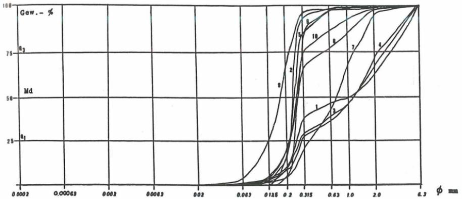
Abb. 3: Korngrößenanalysen aus der Sandgrube Gerecke. Summenkurven einiger Sedimente aus der untersuchten Abfolge (vgl. Profil I und II). Gute bis mäßige Sortierung bei den Proben 2, 5, 6, 8, 9, 10:  $S_o = 1,11 - 1,60$ ;  $M_d = 0,17 - 0,28$  mm. Schlechte Sortierung bei den Proben 1, 3, 4, 7:  $S_o = 1,788 - 3,38$ ;  $M_d = 0,71 - 1,13$  mm.
