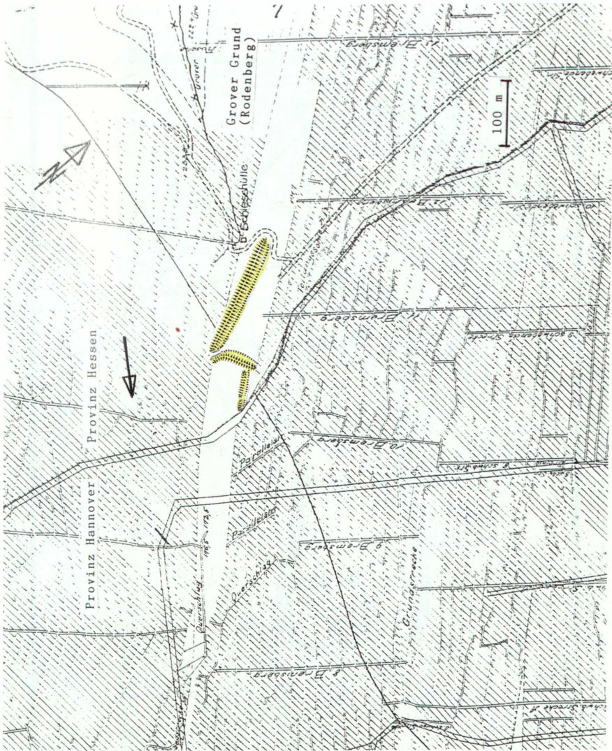
Abb. 2: Quer durch das Bild (oberhalb Bildmitte) verlaufende abbaufreie Zone - ohne Schraffur - im Hauptflöz (Flöz 3) als Folge von Störung II. Störung I wird in Höhe des Knicks der "Fährte" - s. Pfeil - schwebend durchfahren (ferner ist die geänderte Richtung einer Abbaustrecke schwach erkennbar). Der übertägige Aufschüttungskomplex im Bereich von Störung II (s. Abb. 3) ist grob skizziert übertragen (gelb angelegt, links neben der "Schlösschütte"). Ausschnitt der Grubenkarte des Deisters aus dem 19. Jh. mit Ergänzungen.
