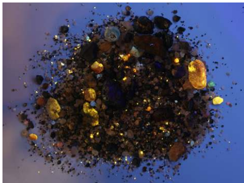
Abb. 2 Schwermineralkonzentrat wie Abb. 1, aufgenommen mit kurzwelligem UV-Licht. Deutlich gelb fluoreszierend zeigen sich die Zirkone. Foto O. Tietz
