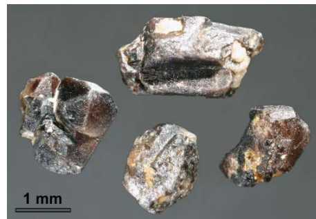
Abb. 4 Cassiterit als Kristalle und Kristallaggregat (links) aus den Sedimenten des Baches bei Ostritz-Altstadt (Nr. 9 in Karte 1). Die Kristalle sind mit hellen Nachbarmineralen verwachsen, was auf kurze Entfernungen zum Liefergebiet hinweist. Foto O. Tietz
