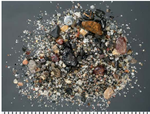
Abb. 1 Schwermineralkonzentrat aus dem Quellgebiet des unbenannten Baches Ostritz-Altstadt (Nr. 9 in Karte 1), Ausbeute aus ca. 5 Liter Bachsediment nach dem Waschen. Maßstab mit mm-Einteilung. Foto O. Tietz
