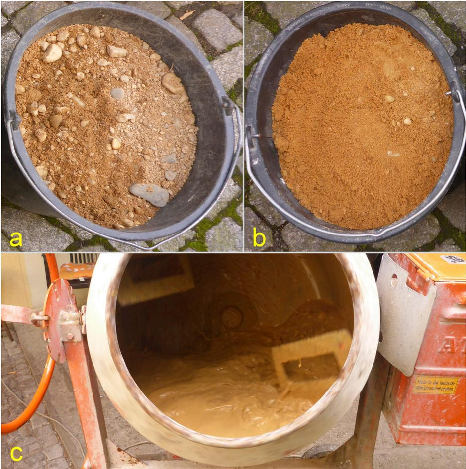
Abb. 5: Für das Experiment verwendete Sedimentproben. (a) 16 l Sand-Kies-Gemisch (b) 9 l Sand (c) Betonmischer befüllt mit insgesamt 25 l Sand-Kies-Gemisch + 10 l Wasser. Das Sediment bewegt sich überwiegend rollend bis kaskadierend (vergl. Abb. 3). Die Mischflügel in der Trommel sorgen neben einer zusätzlichen Durchmischung des Sedimentes dafür, dass Teile dessens in springende, der Saltation vergleichbare Bewegungen versetzt werden.
