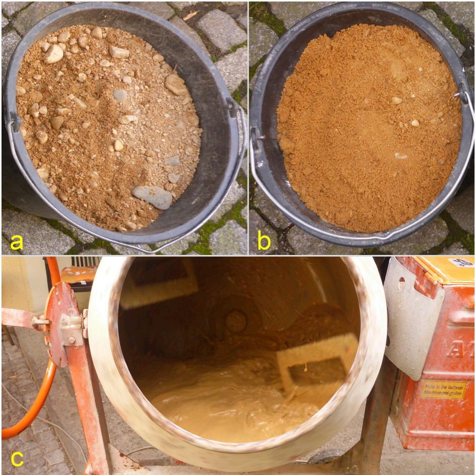
Abb. 5: Für das Experiment verwendete Sedimentproben. (a) 16 l Sand-Kies-Gemisch (b) 9 l Sand (c) Betonmischer befüllt mit insgesamt 25 l Sand-Kies-Gemisch + 10 l Wasser. Das Sediment bewegt sich überwiegend rollend bis kaskadierend (vergl. Abb. 3). Die Mischflügel in der Trommel sorgen neben einer zusätzlichen Durchmischung des Sedimentes dafür, dass Teile desselben in springende, der Saltation vergleichbare Bewegungen versetzt werden.
