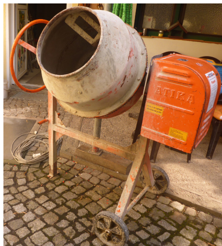
Abb. 4: Für das Experiment als Abriebtrommel genutzter Betonmischer Rapid des Herstellers ATIKA.
