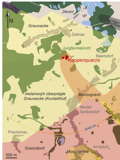
Abb. 7: Kartenausschnitt des Fundgebietes der Kappenquarze einschließlich einer vereinfachten, überlagernden geologischen Karte (nach LANGE et al. 2004, Anlage I). Die roten Punkte zeigen die Lage der Pegmatite mit Kappenquarzen. Der große rote Punkt zeigt die Lage des Hauptfundortes im Waldstück „Jungfernkänicht“ bei Diehsa. Hinweis: Die Farbunterschiede für Flächen mit Ortschaften, Wäldern, Wasser und Straßen sind allein der Überlagerung durch die geologische Karte geschuldet und haben keine weitere Bedeutung.
