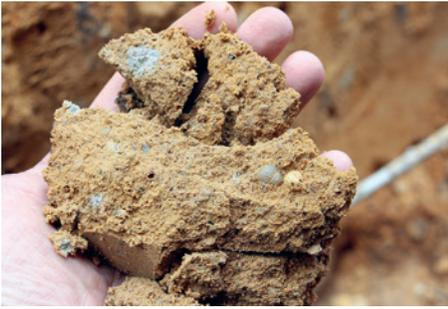
Abb. 18: Geschiebelehm mit hellgrauen Sandeinschlüssen (besonders links) und Quarzgeröllen (rechts), wahrscheinlich eine wurzellose oder aufgestauchte Scholle der Elster-1-Grundmoräne in Schmelzwasserablagerungen der Elster-2-Kaltzeit (Vorschüttbildungen). Baugrube von Haus D, westlicher Bereich der Nordböschung. Foto: O. Tietz, 26.10.2021
