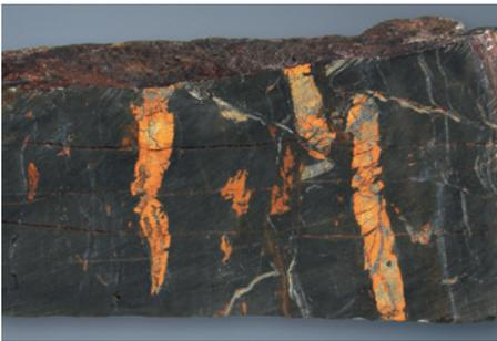
Abb. 6b: Anschnitt von schwarzgrauem Biotitschiefer mit bandförmigen, hellen Einlagerungen von Kiesel-schiefer, Fundstelle 6, Stufengröße 15,5×6,5 cm, SMNG Nr. 19673a,1
