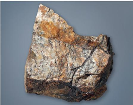
Abb. 5: Schwarzbrauner Goethit füllt die Klüfte in hellem, vermutlich gebleichtem Kieselschiefer aus. Stufengröße 7×6×4 cm
