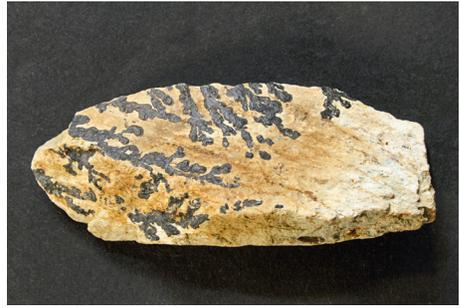
Abb. 9: Mangandendriten auf Phonolith, Steinbruch Zimmermann. Sammlung W. Lange, Samml.-Nr. L 351, Stufenbreite 100 mm
