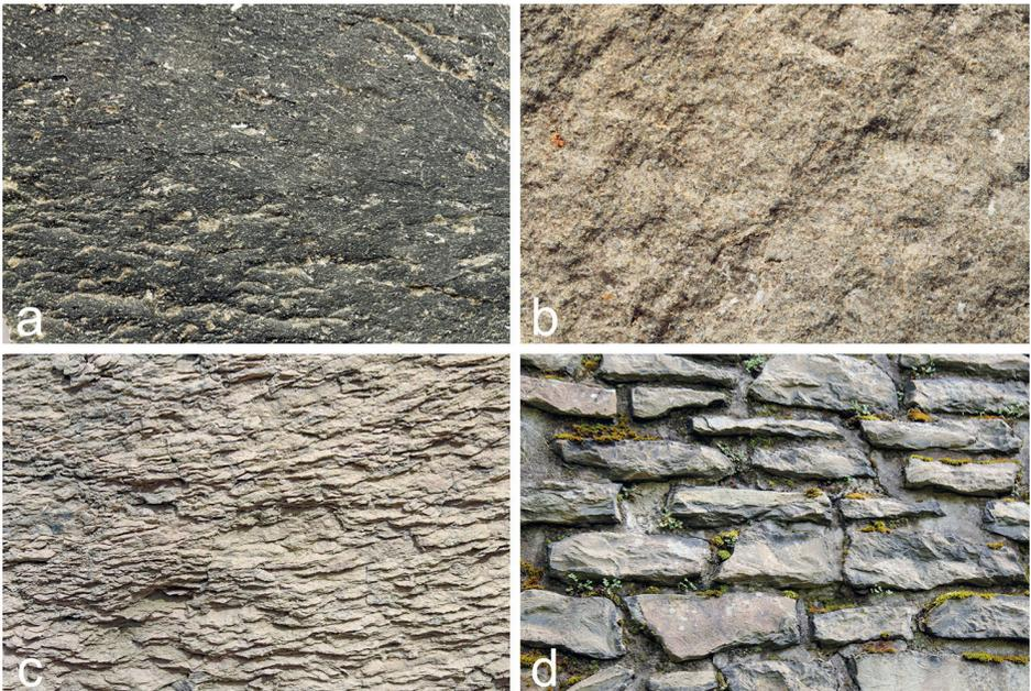
Abb. 6: Phonolith-Gesteinsoberflächen. a: frischer Phonolith aus dem Zimmermann-Bruch, Bildbreite 60 mm; b: angewitterter Phonolith aus dem Niederen Ratsbruch, Bildbreite 60 mm; c: verschiefter Phonolith in situ, Oberer Ratsbruch, Bildbreite 300 mm; d: Viadukt im Schülerertal, Bruchsteinmauer aus Pethauer Phonolith. Fotos Abb. 6–9: W. Lange
