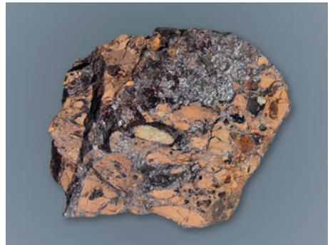
Abb. 5: Konglomerat aus Geröllen von braunem, Fe-haltigem Tonschiefer (deutlich überwiegend) und hellfarbigem Hornstein (mittig angebrochen, oval). Die Klüfte füllt schwarzbrauner, zum Teil pechglänzender Goethit aus. Stufengröße 9×7×3 cm.
