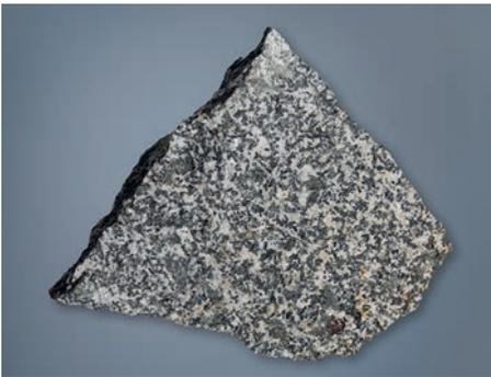
Abb. 2: Das zum großen Teil aus grauweißem Feldspat und dunkelgrünen Amphibolen bestehende Gestein im Anbruch. Der mittelgraue Quarz ist nur unter dem Mikroskop zu erkennen. Baugrube der Ersatz-WKA, Stufengröße 12×10×3 cm.
