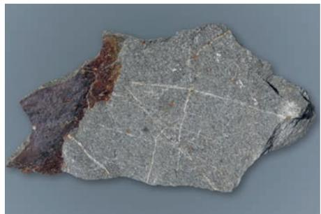
Abb. 9: Die frische, graugrüne Grauwacke im Anbruch. Zu erkennen sind grauweiße, sich teilweise kreuzende „Äderchen“ von Mineral-Verwachsungen (s. Text). Stufengröße 8,0×4,5×2,0 cm.
