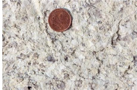
Abb. 12: Bruchfläche des Granodiorit-Kaolins vom Ton-Kaolin-Tagebau Wiesa-Hasenberg bei Kamenz mit typischem Granitgefüge. Graubraun = Quarz, weiß = kaolinisierter Plagioklas, hellgelb = kaolinisierter Orthoklas und Biotit. Foto: O. Tietz, 15.3.24
