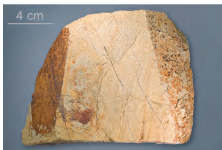
Abb. 18a: Halbfeste, mittelstark kaolinisierte Grauwacke. Handstück vom 6. Abbaustoß im Nordfeld des Kaolintagebaues Ebersbach. Lage des Fundpunktes siehe Abb. 19, links der Mitte. Probe 24/02/12-1a des SMNG. Foto: O. Tietz
