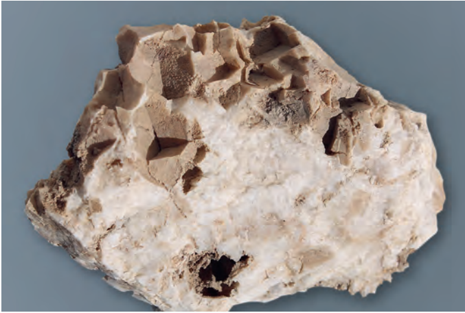
Abb. 10: Gangquarz mit Hohlräumen weggelöster Minerale bzw. Perimorphosen, Stufengröße 10,0×6,5×4,0 cm, Südfeld, Planum der 3. Sohle.
