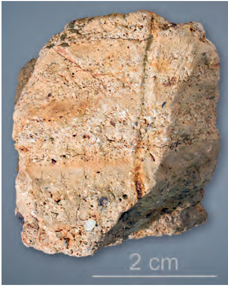
Abb. 30: Gebänderter Tuff mit vertikalem Entgasungskanal. In dem Stück sind unten und in der Mitte zwei hellere grobe Aschenkornlagen sichtbar. Probe 3 (Lage s. Abb. 24). Foto: O. Tietz
