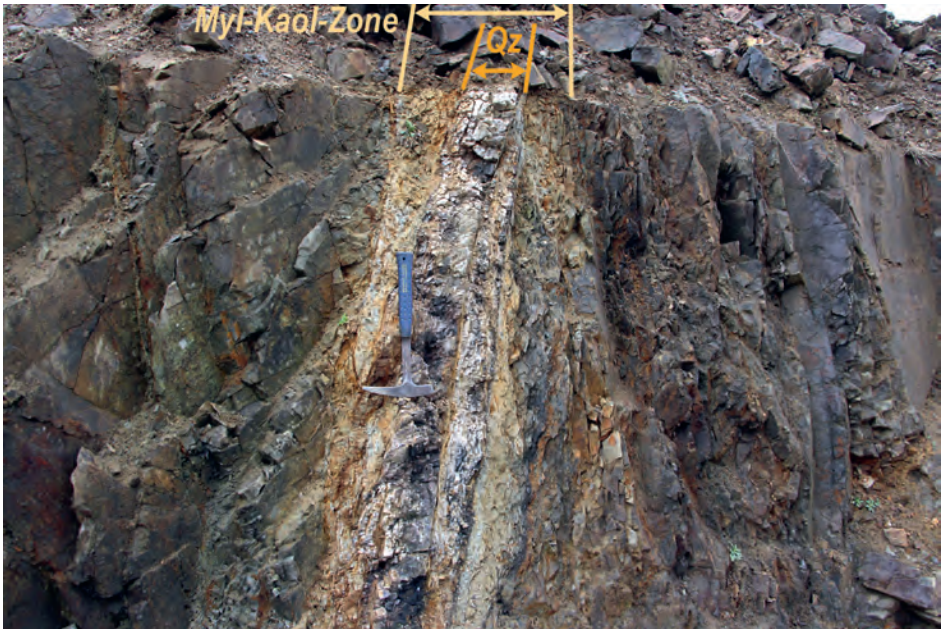
Abb. 21: Steil stehender Quarzgang (Qz) in unverwitterter Grauwacke. Blick nach W auf den 5. Abbaustoß im Nordfeld des Kaolintagebaues Ebersbach. Der Gang streicht E-W und fällt mit 80^\circ nach S ein ( 185^\circ/78^\circ , n=4 ). Deutlich sind im 20–26 cm mächtigen Gang randparallele Scherungen (rechts: nach oben auskeilender Phacoid) und Mn-Vererzungen (schwarze Zonen) zu erkennen. Weiterhin gibt es zahlreiche Risse (Querklüfte) und randparallele Quarztrümer (links unterhalb des Hammers). Gangparallel ziehen deutlich heller verfärbte Grauwackenpartien. Diese Zonen (Myl-Kaol-Zonen) sind vermutlich das Ergebnis einer Mylonitisierung (Zerreibung der Grauwacke zu Gesteinsmehl durch gangparallele Bewegungen) und anschließenden Kaolinisierung (Hellfärbung, ein Hinweis auf chemische Verwitterung). Foto: O. Tietz, 12.2.2024.
