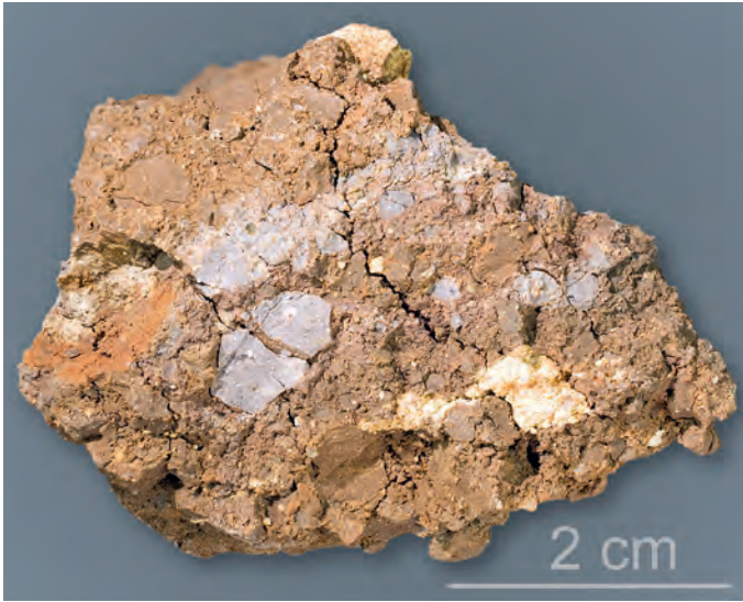
Abb. 27: Rotbrauner Tuffit (Lahar) mit Vulkanitklasten (blaugrau, besonders in der Mitte und braun, unauffällig, z. B. links oben und unten) und zwei, z. T. semiplastisch deformierte Granitkaolin-Einschlüsse (hellgelb, rechts unten). Probe 5b (Lage s. Abb. 24). Foto: O. Tietz
