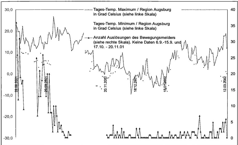
Abb. 11: Auf der linken Skala aufgetragen das Tagestemperatur-Maximum und -Minimum in der Region Augsburg; auf der rechten Skala die Nutzungsaktivität am Kellerzugang Altenmünster (Anzahl der täglichen Auslösungen des Bewegungssensors).
