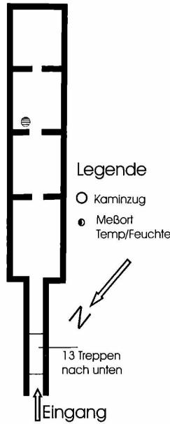
Abb. 16: Grundriss der Kelleranlage in Langenreichen. Mit einer Länge von fast 40 Metern ist der Keller ungewöhnlich lang. Der Lagerkeller liegt ca. 2 Meter unter dem Niveau des Eingangs. Der Kellereingang ist nach NW ausgerichtet.
