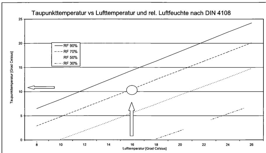
Abb. 3: Tritt im Sommer warme Luft in einen kühleren Keller ein, so führt dies zu einem Anstieg der Luftfeuchte. Bei 100% r.F. wird die Taupunkttemperatur erreicht. Kondensation tritt ein, die Folge sind feuchte Wände oder ein Abtropfen von Wasser an der Decke. Ablesebeispiel: Luft, die mit einer Temperatur von 16°C und 70% r.F. in einen Keller eintritt, kondensiert ab 11,6°C oder weniger (siehe Pfeile).
