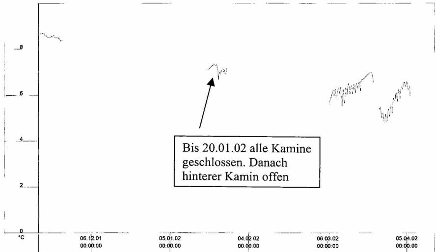
Abb. 14: Temperaturwerte des Kellers Zusammzell. Zeitbereich 16.11.2001 bis 15.04.2002. Zusammzell war der wärmste der gemessenen Kellern. Einer der beiden Lüftungskamine ist dauerhaft verstopft, der andere war geschlossen und wurde am 20.01.2002 geöffnet. Nach der Öffnung gleicht sich die Temperatur den anderen Kellern an.
