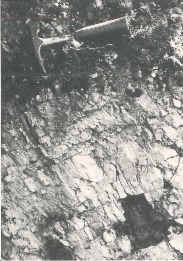
Abb. 8: Regelmäßige, dichte Zerklüftung im Massenkalk der allochthonen Weißjurascholle NW' Marxheim (R 22 200, H 01 940).
