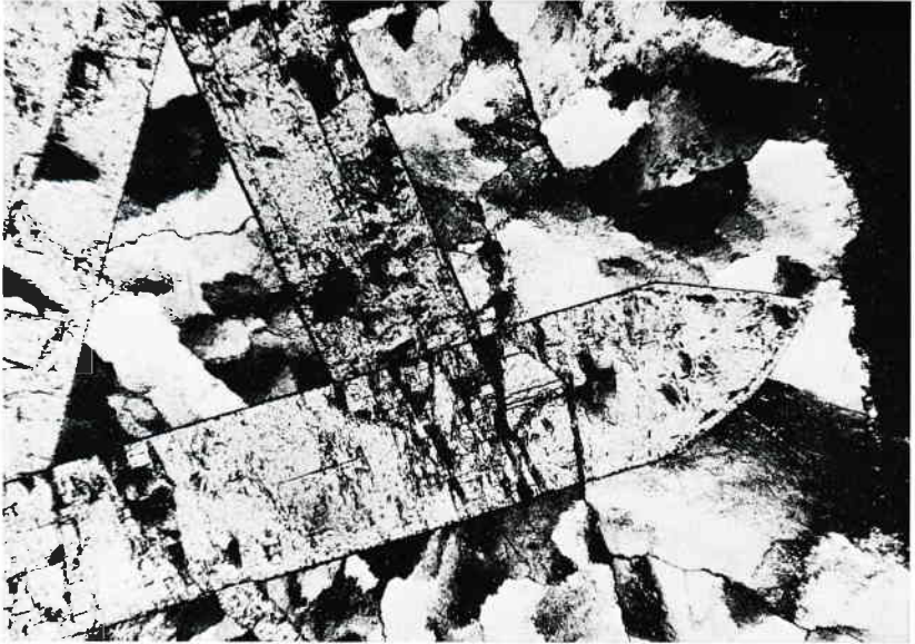
Abb. 17: Mikroskopische Aufnahme eines Dünnschliffs: Geoden-Schwundrißfüllung (Lias von Berghagen/Werther). Tafelige Barytkristalle in einem Gemenge ankeritischer Carbonate. Polarisiertes Licht und Analysator (= gekreuzte Polarisatoren). Bildausschnitt: 2,4 x 1,7 mm.
