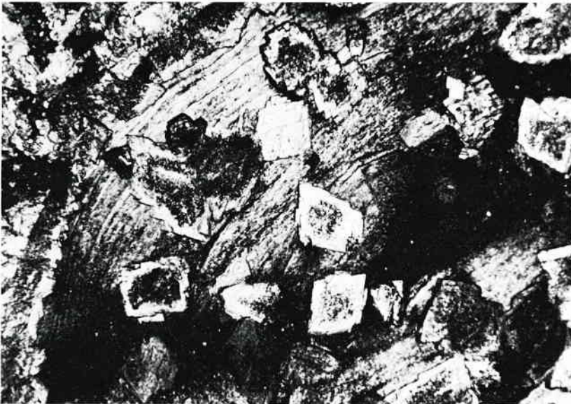
Abb. 26: Mikroskopische Aufnahme eines Dünnschliffs: Ausschnitt aus einem Chamosit-Ooid mit Neubildungen von Carbonat-Rhomboedern. Macrocephalenoolith vom Häverstädter Berg (Porta Westfalica). Polarisiertes Licht mit Analysator (= gekreuzte Polarisatoren). Bildausschnitt: 0,85 x 0,6 mm.
