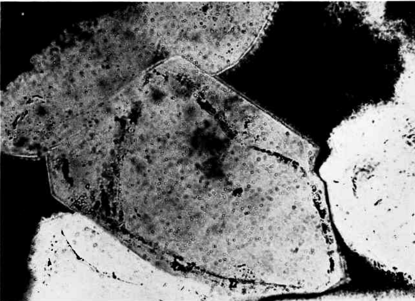
Abb. 29: Gleiche Aufnahme bei Anwendung polarisierten Lichtes mit Analysator (= gekreuzte Polarisatoren). Tertiärquarzit, Fundort: Hoher Hagen bei Dransfeld.
