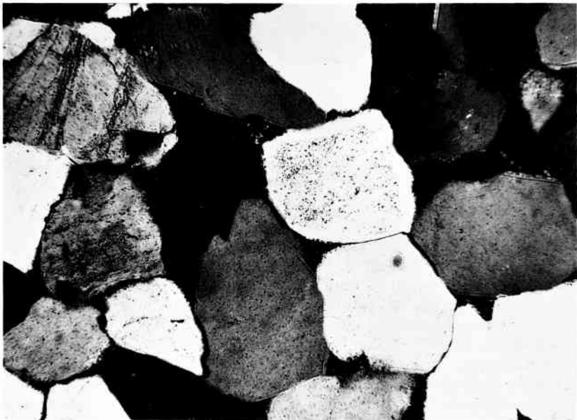
Abb. 27: Gleiche Aufnahme bei Anwendung polarisierten Lichts mit Analysator (= gekreuzte Polarisatoren). Tertiärquarzit, Fundort: Hoher Hagen bei Dransfeld.
