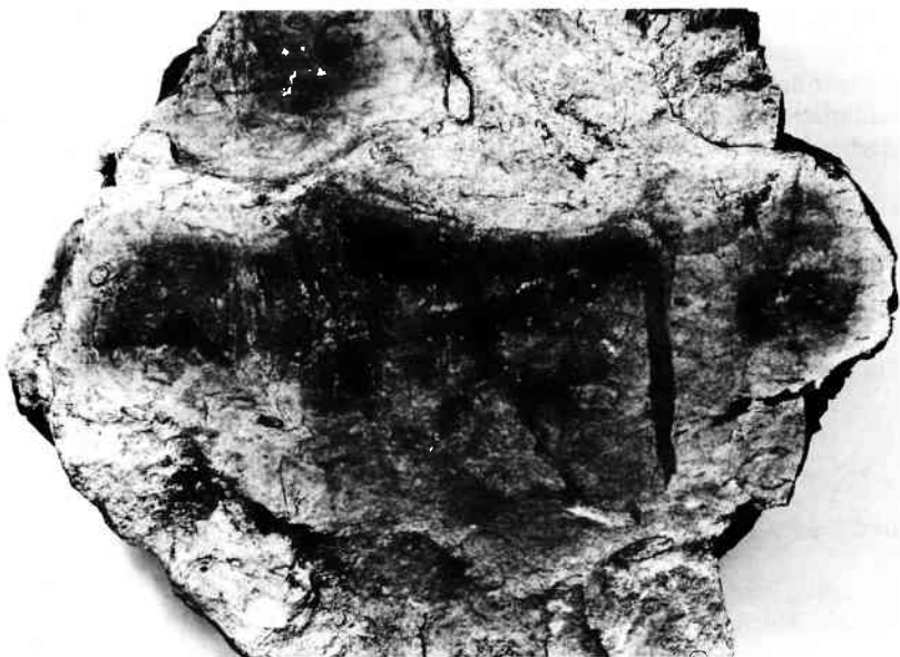
Abb. 64: Belegstück eines Flammenmergels mit Hornstein-Konkretion (in der Mitte der Probe) - ohne scharfe Grenzen. Fundort: Alter Steinbruch nördlich Hahnenkämpen, Bielefeld, 24. 8. 1975. Bildausschnitt: 220 × 145 mm.
