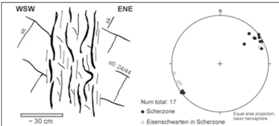
**Abb. 6:** Skizze und Stereogramm zur steil stehenden Scherzone am Punkt Schwedenschanze 2. Die Scherzone ist ca. 20 bis 25 cm mächtig, von intensiven Eisenaussärlungen (dicke schwarze Linien in der Skizze) durchzogen und lässt sich auf beiden Seiten des Hohlwegs verfolgen.
