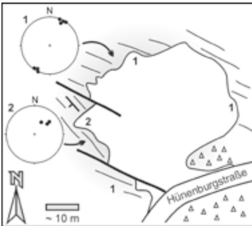
**Abb. 9:** Skizze des Oberen Hünenburgsteinbruchs mit tektonischem Inventar. Zwei senkrechte Störungen trennen einen Homogenbereich (2) mit abweichendem Einfallen von dem übrigen Teil des Steinbruchs (Bereich 1) ab. Die Störungen verlaufen parallel zur saigeren Schichtung, die den Hauptteil des Steinbruchs dominiert.
