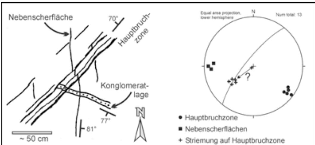
**Abb. 10:** Strukturelemente einer Bruchzone im großen Steinbruch unterhalb des Hünenburgturms. Die Zone ist scharf begrenzt, 30 bis 80 cm breit und über 50 bis 100 m zu verfolgen. Innerhalb der Bruchzone engständige Scherflächen mit sehr deutlicher Harnischstriemung, aber kaum beobachtbarem Versatz. Die Striemung weist klar auf Diagonalebewegungen hin, ob es sich aber um eine Schrägauf- oder Schrägabschiebung handelt, ist unklar.
