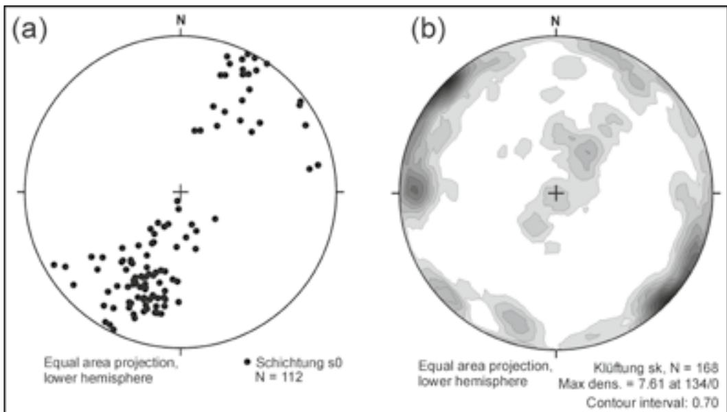
**Abb. 13:** Stereographische Projektionen der Gesamtstrukturdaten aus allen bearbeiteten Aufschlüssen (a): Schichtung, und (b): Klüftmessungen, aufgenommen in den beschriebenen Aufschlüssen. Flach einfallende Klüfte sind evtl. unterrepräsentiert (siehe Text). Rotation früh angelegter Klüftung im Zuge fortschreitender Deformation (bei Haupteinengung in Richtung NE-SW) führte zur Streuung von Längs- und Diagonalklüften.
