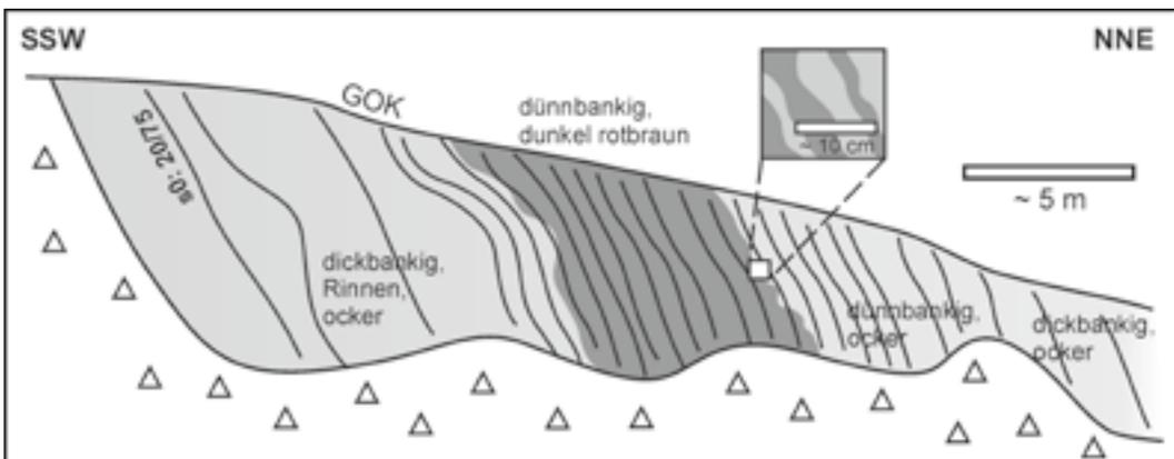
**Abb. 12:** Skizze der westlichen Aufschlusswand im Steinbruch Kammweg 1. Etwa schichtparallele Braunfärbung (Hämatit mit XRD nachgewiesen) im mittleren Wandteil. Die Übergänge zum ockerfarbenen Sandstein sind teils diffus-schlierig.
