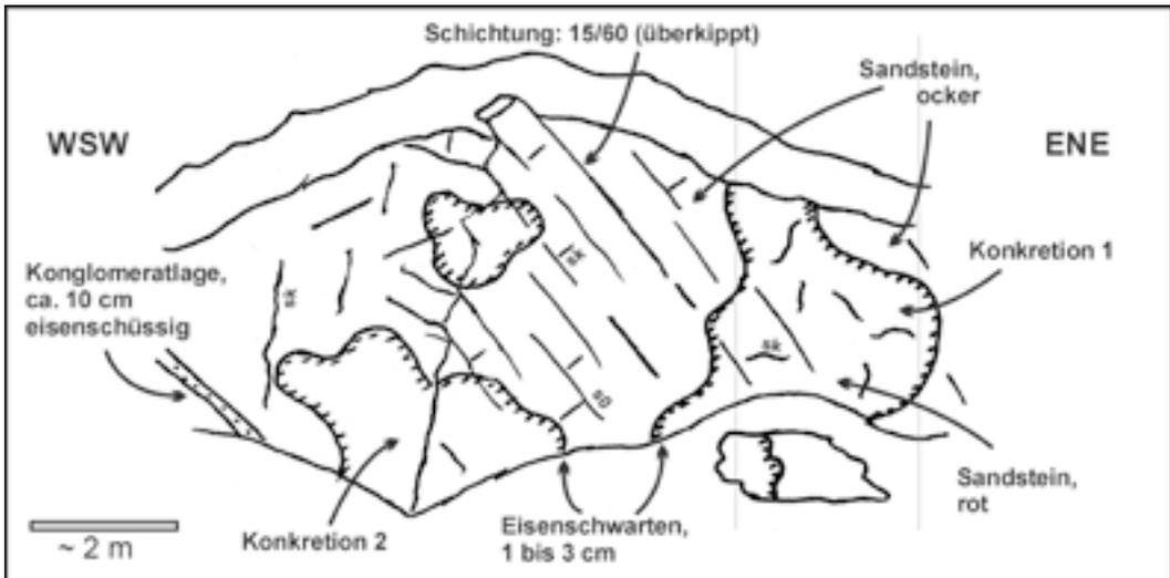
**Abb. 11:** Skizze des zentralen Teils der Aufschlusswand im Steinbruch Ebberg westlich der Gaststätte "Eiserner Anton". Eisenschwarten trennen unterschiedlich gefärbte Sandsteinpartien voneinander. Beachte die undeutlichere Schichtung und unregelmäßige Klüftung in Konkretion 1 (Strukturwerte siehe Text).
