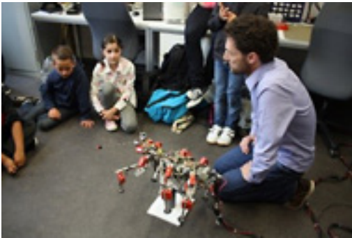
Abb. 3: Labor der Bio-Kybernetik. Als Vorbild für diesen Roboter dienten die Laufeigenschaften von Stabheuschrecken.
