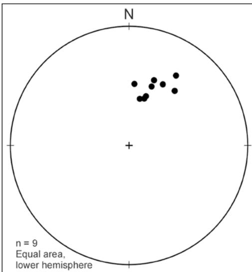
**Abb. 3:** Stereogramm der gemessenen Schichtfallwerte im Bocketal.
