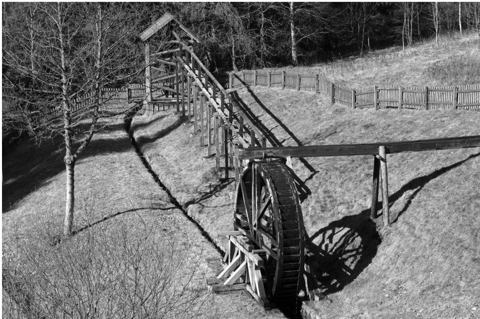
Abb. 1: Das Prinzip der Wasserkraftnutzung im Oberharz Umwandlung in mechanische Energie verdeutlicht das rekonstruierte Kunstrad (vorn) in Clausthal, bei der die kinetische Energie des gespeicherten Wassers über das Feldgestänge (Mitte) auf die Einrichtungen der Gruben übertragen wird.
