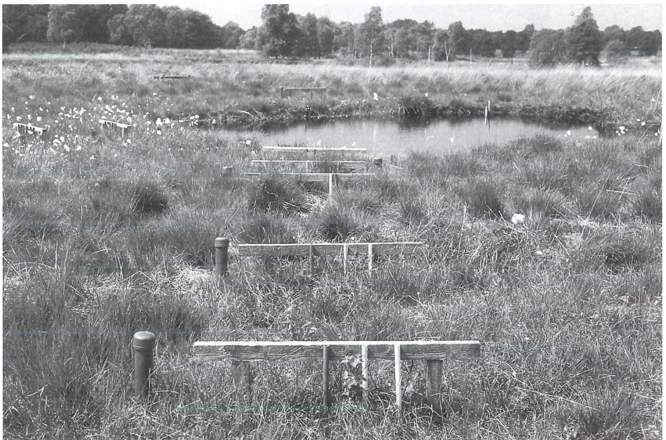
Abb. 6: Künstlicher Kolk mit Meßeinrichtungen zu Untersuchungen der Wasserstände und des hydrologischen Potentials im Dosenmoor, Schleswig-Holstein.
