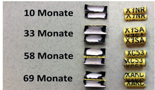
Abb. 10: Schadensbilder der Ringinnenoberfläche nach unterschiedlichen Tragedauern. – Signs of wear off the inner ring surface after different carrying durations.
