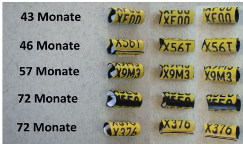
Abb. 9: Typische Schadensbilder von Kennringen nach unterschiedlichen Tragedauern. – Typical signs of ring wear after different carrying durations.
