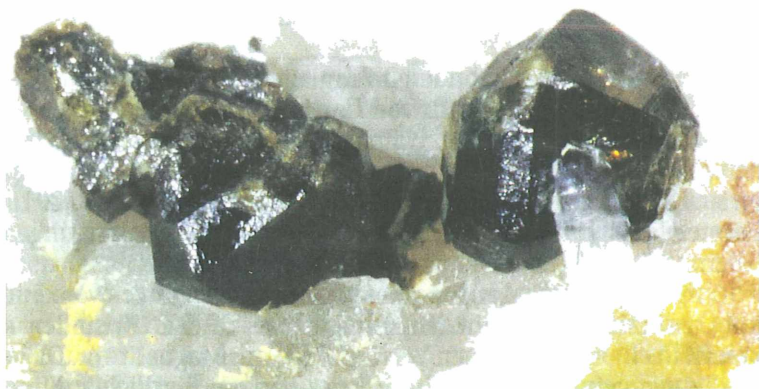
Abb. 3: Cassiterit-Kristalle (rechts verzwillingt) auf Quarz vom Gupfen bei Eisenbühl (Lkr. Hof). Derartig isometrische Kristalle sind typisch für hohe Bildungstemperaturen unter den Bedingungen der Pneumatolyse. Die Bildbreite beträgt 7 Millimeter. Sammlung: KORTHALS, Foto: CRASSER.
