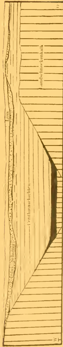
12a. Schematische Darstellung der Steinbruchs-Wand im großen Kalkbruch bei Flörsheim. Nach W. Wenz.
