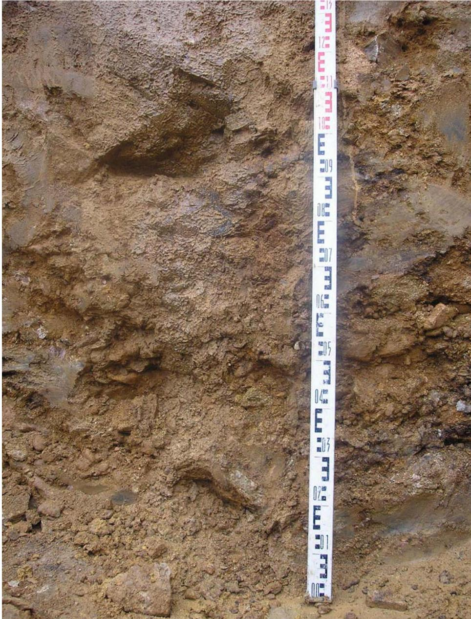
**Abb. 3:** Detailaufnahme der älteren Schotter im Untergrund einer Baugrube (Baugebiet Eck II, Bollschweil).
