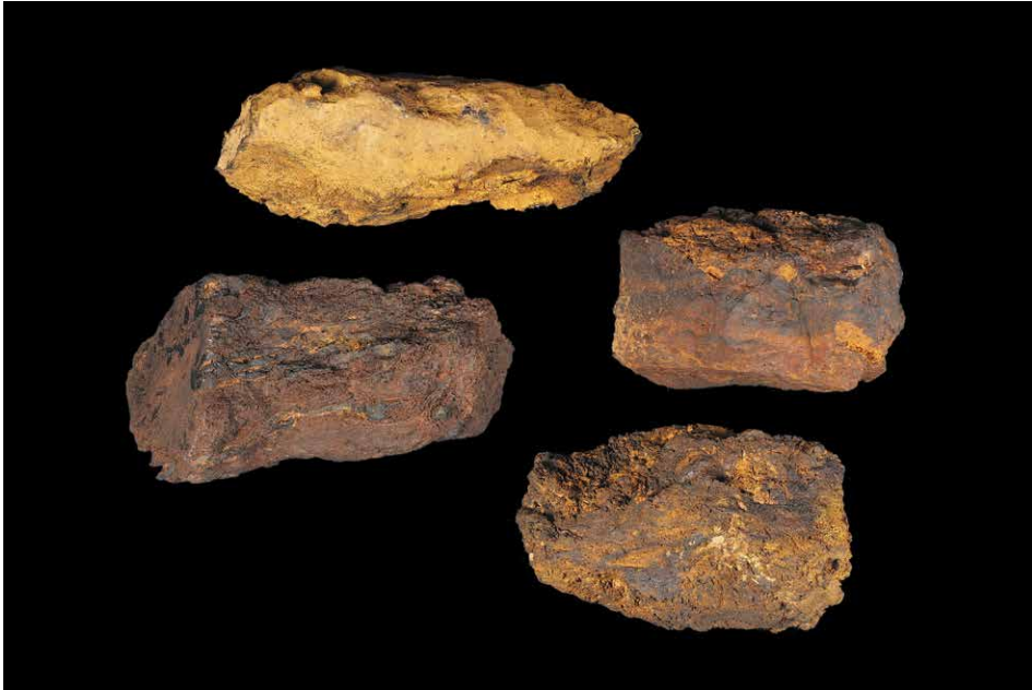
Abb. 9: Reinerzproben aus dem Schurfeld am „Schneckenberg“. Die eisenreichen Erze bestehen überwiegend aus Eisenhydroxiden (Goethit), doch tritt auch Hämatit verbreitet auf. Das obere Stück zeigt äußerlich beispielhaft die charakteristische Farbe der Ockersande. Bildbreite 14 cm. Sammlung und Foto Helge Steen. Fig. 9: Reinerz samples from the Schneckenberg mining field. The iron-rich ores consist mainly of iron hydroxides (goethite), but haematite also occurs widely. The upper piece shows externally the characteristic colour of the ochre sands. Image width 14 cm. Collection und Photo: Helge Steen.
