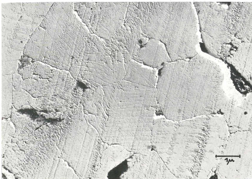
Abb. 11: Splitterkalk wie Abb. 10, geschliffen und poliert Elektronenmikroskopische Aufnahme eines Lackabdruckes, mit \text{WO}_2 im Hochvakuum schräg bedampft. Präp. Dr. Seeliger
