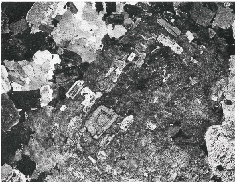
Abb. 3: Alkalifeldspatgroßkristall mit orientiert eingelagerten Plagioklas- und Biotitkristallen. Zonarbau nur in Andeutungen erhalten. Schnitt etwa parallel (110).
