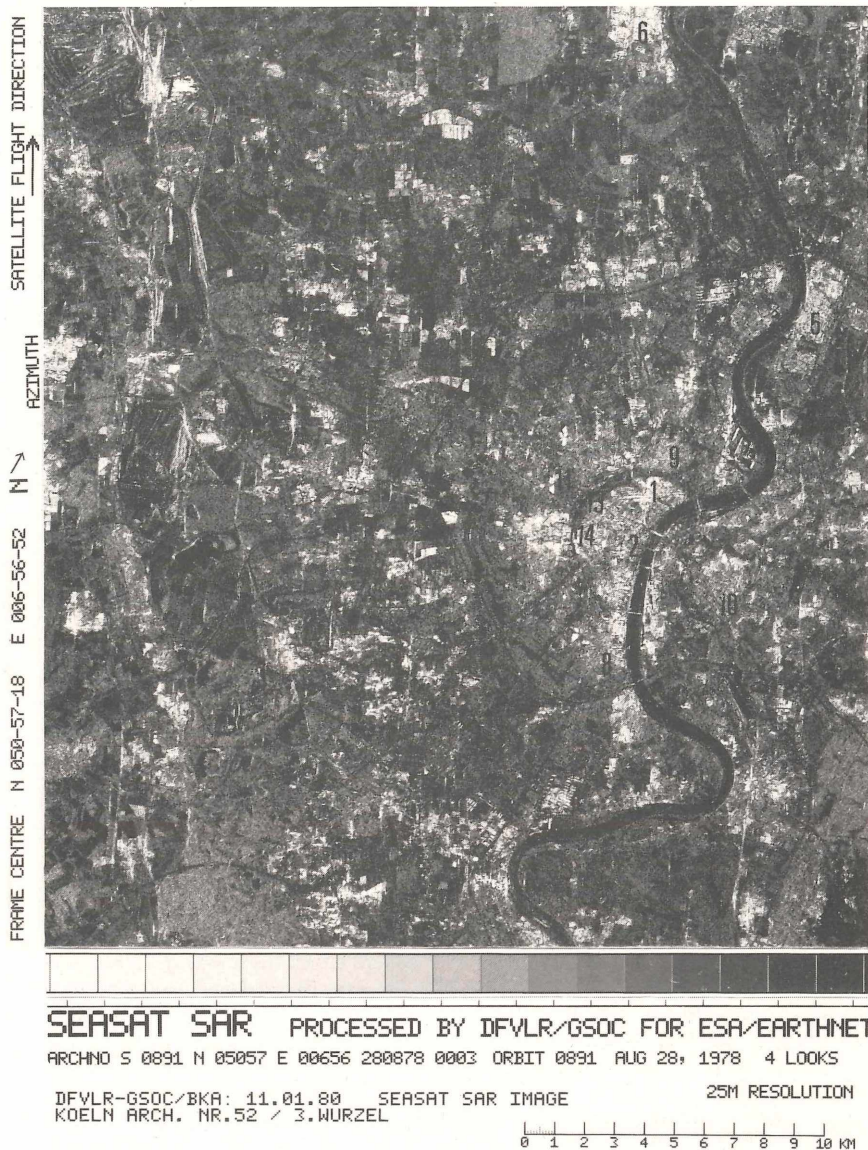
Abb. 8: SEASAT-SAR-Bild der Kölner Bucht vom 28. August 1978 aus einer Entfernung von 800 km, digital prozessiert von der DFVLR; Maßstab 1 : 250 000
