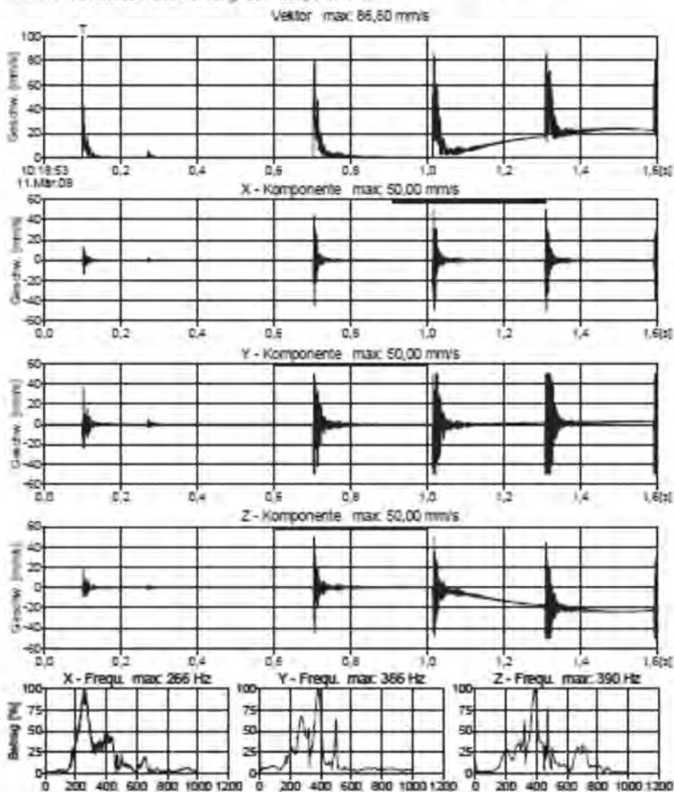
*Beispiel für eine Messung von Geophon 1 während der Beräumung von Felswänden im Steinbruch Spitz im März 2008:*
