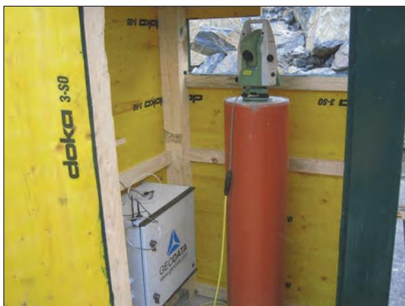
*Hütte mit vollautomatischen Tachymeter*
