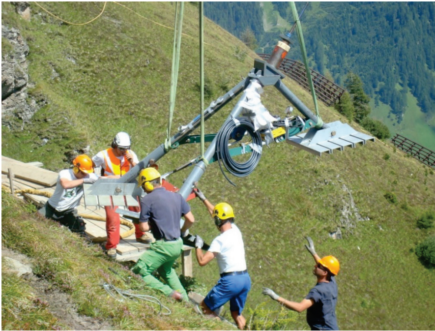
Abbildung 8: Dreibein-Prüfeinrichtung für Abnahmeprüfungen (WLV Imst).
