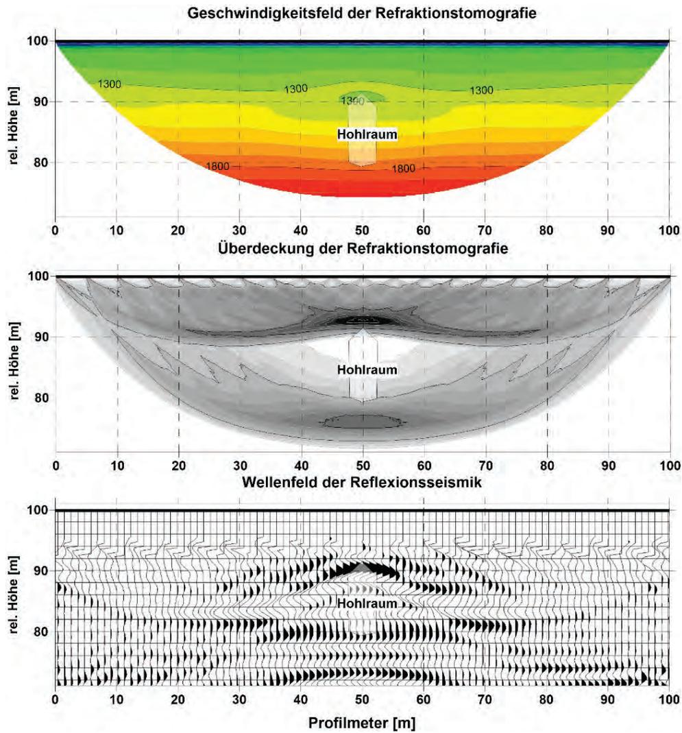
Abbildung 1: Charakteristika einer refraktionstomografischen und reflexions-seismischen Detektion eines Hohlraums anhand eines synthetischen Modells (oben – Minima im Geschwindigkeitsfeld, Mitte – fehlende Strahlenüberdeckung (weiss) im Bereich des Hohlraums), unten – hyperbelartige Reflexionen).
