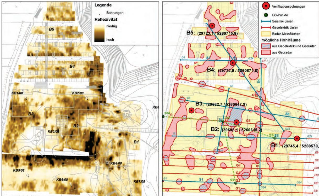
Abbildung 6: Darstellung einer flächenhaften Radaraufnahme in Reith (Tirol); links – Reflexivität, rechts – Interpretation
