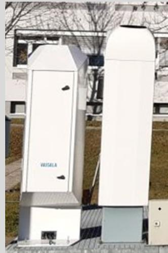
Abb.3: Testweiser Parallelbetrieb der Ceilometer CL51 (rechts) und CL61 (links)
