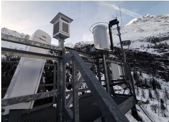
Abb.1: Messplattform in Kolm-Saigurn mit Ceilometer CL51 (links)
