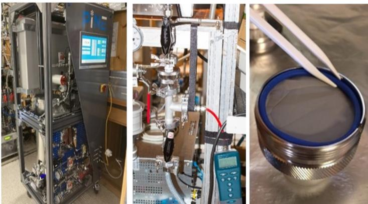
Abb.2: Beitrag von NF CIS SBO zu CCIce. Links befindet sich das Instrument PINE zur Analyse von Eiskeimbildungsprozessen, welches vom KIT im Zeitraum von 2021-2023 am SBO getestet wurde. Im Rahmen des AeroCloud-AT Projekts wird das SBO in 2026 eine PINE für den Monitoringbetrieb erhalten. Rechts: Filter und Impaktor genannt „INSEKT“ zur offline Bestimmung von Eiskeimbildungsprozessen. Das INSEKT-Monitoring wird aktuell in Kooperation mit dem KIT durchgeführt.
