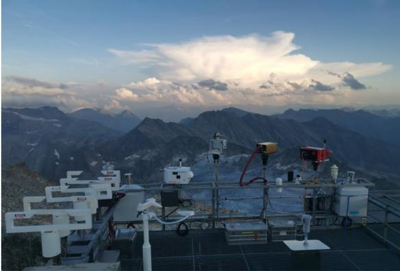
Abb.1: Messinstrumente auf der Wolkenterrasse: GFAS-DPOL (Uni Stockholm), Fog-Monitor (FMI, ETH-Z), CDA (FMI), Poleno Mars (Swisens) , PVMs, PWD
