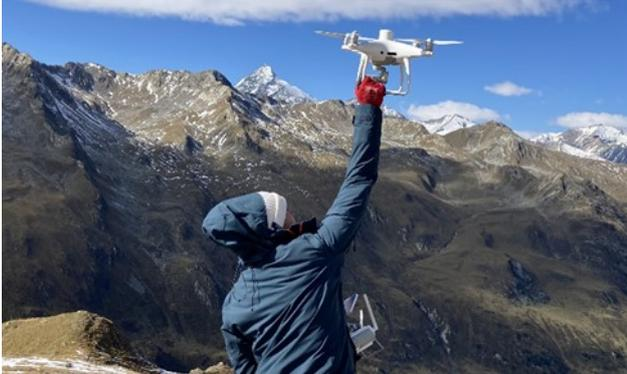
Abb.1: Vermessung der Gletscheroberfläche mit der dji Phantom 4 RTK
