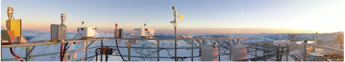
Abb.1: Beitrag von NF CIS SBO zu CCPar. Verschiedene Spektrometer zu Erfassung von Wolkenpartikeln und Spektren. Z.B. Fogmonitor (DMT), GFAS-DPOL (DMT), wie auch CDA (Palas GmbH). Aufnahme zeigt Messaufbau während der Vergleichsmesskampagnen ECCINT-INT01. Mittig befindet sich das holographische Prototyp ICEMET (Uni Oulu). Der Betrieb von Spektrometern im Hochgebirge ist herausfordernd..
