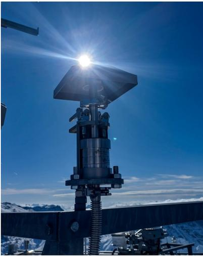
Abb.1: Kaskadenimpaktor zur Erfassung von Mikro- und Nanoplastik
