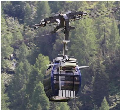
Abb.1: Nutzung der Sonnblick Seilbahn für Vertikalprofilmessung
