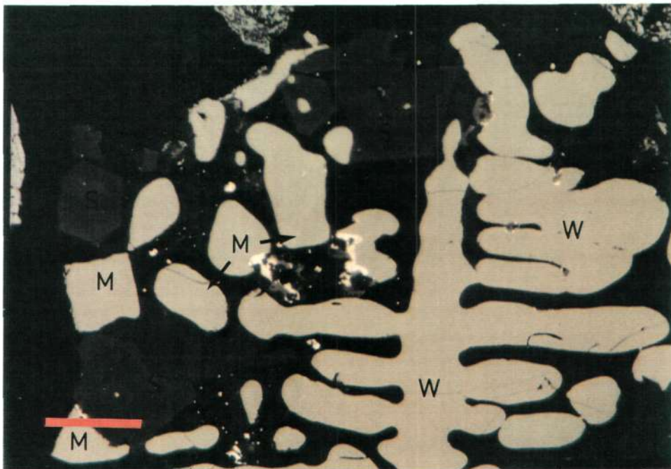
Abb. A13: Schlacke mit dendritischem Wüstit (W), Magnetit (M), zonar gebauten Spinellkristallen (S), Magnetkies (weiße Einschlüsse) und Glasphase (schwarz).
