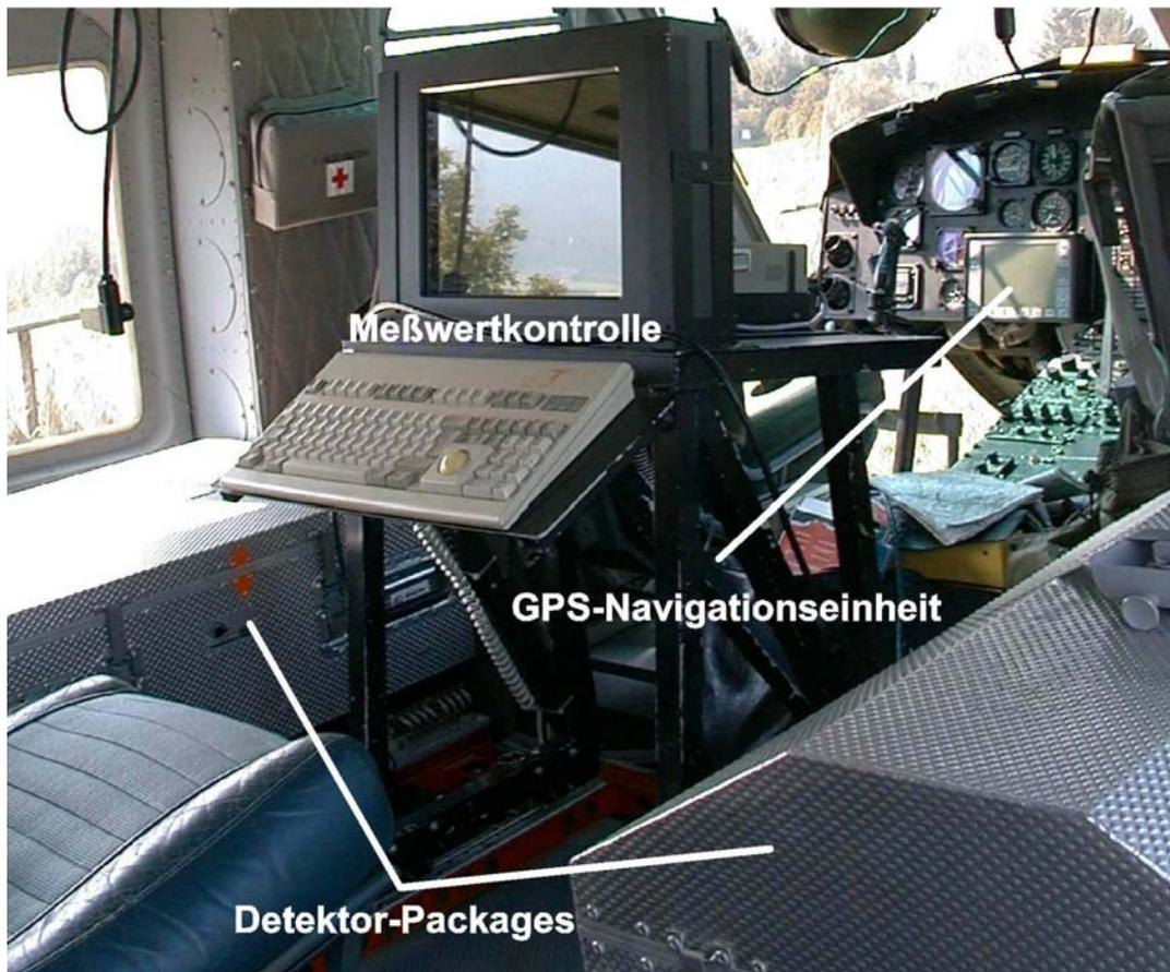
Abb. 2: Arbeitsplatz im Helikopter. Die 2 Detektor-Packages beinhalten ein Detektorvolumen von insgesamt ca. 34 l. Die Messwertkontrolleinheit dient zur Steuerung der Messung und zur laufenden Kontrolle der Messergebnisse. Die GPS-Navigationseinheit zeigt dem Co-Piloten die Position und die Abweichung vom vorgegebenen Flugweg.
