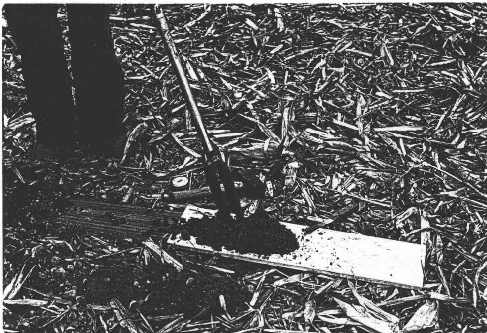
Abb. 8: Handbohrgerät zur Untersuchung der Ausbildung der Deckschichten und Lage der Kies-Oberkante
