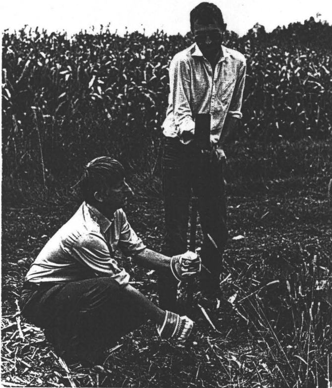
Abb. 6: Messung des Grund- wasserspiegels mit dem Lichtlot
