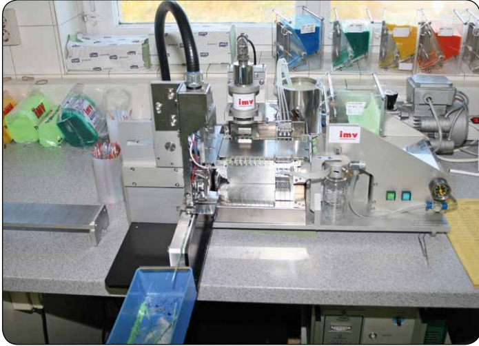
↑ Maschinelle Abfüllung des Spermas in Pailletten
